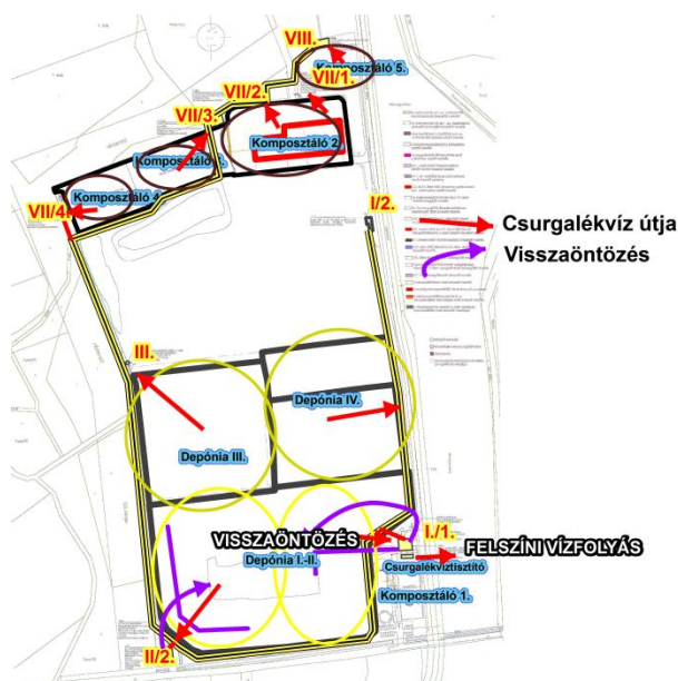
1. ábra: Csurgalékvíz-elvezető rendszer sematikus ábrája Forrás: Belső vállalati anyagok alapján
