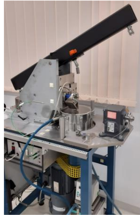
1. ábra. Az alkalmazott koptató berendezés
