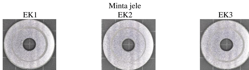
4. ábra. A koptatott tárcsák fotói az EK jelű mintáknál
