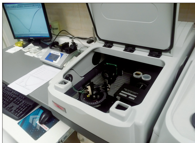
1.b) ábra: Thermo Scientific FT-SPR készülék, SPR TM 100 modul (és a Nicolet TM 6700 FT-IR Spektroszkóp)
