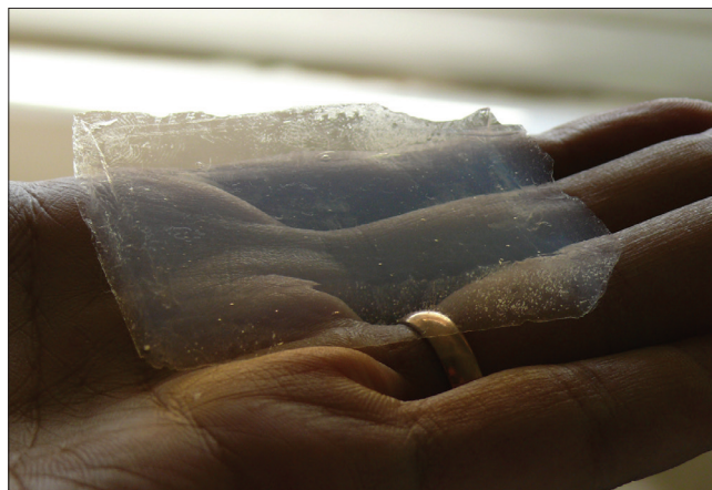
1. ábra: Egy szilika aerogél monolit látható az egyik szerző (L. I.) tenyerén
