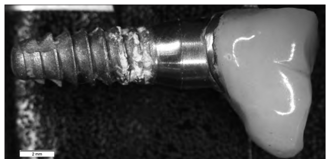
1. ábra: Az esztergált korong (a) és az 1 (b) és 2 (c) jelű explantált implantátumok sztereomikroszkópos felvételei
