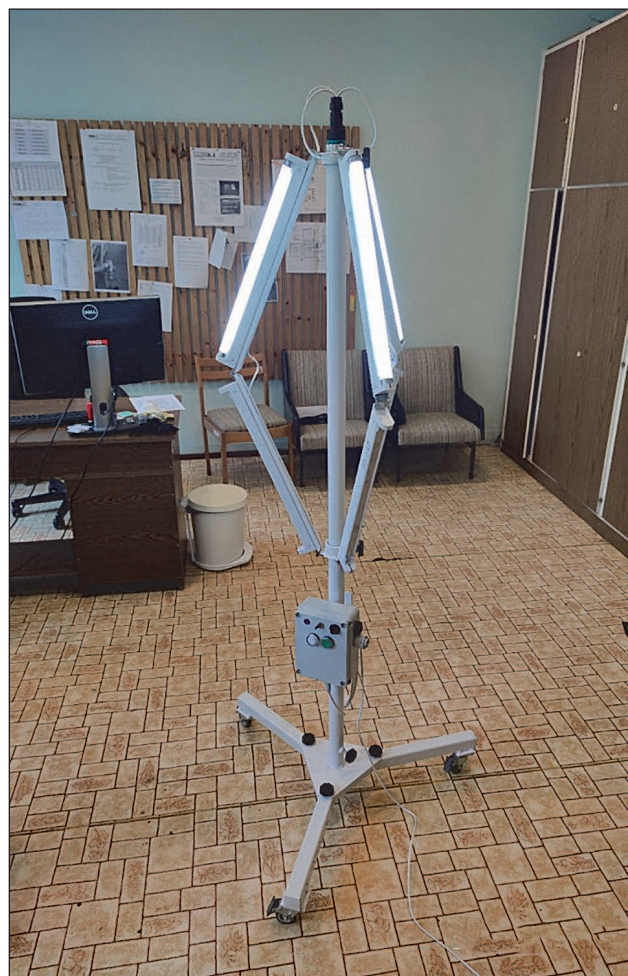
4. ábra. Az UV-Clean egyik prototípusa a HM ArmCom telephelyén. A vezérlődoboz felett látható a csúszógyűrű, ami az árbóchoz képest éppen kb. 30°-os szögben tartja a fénycsöveket. Az alsó foglalatokban nincs fényforrás, a felsőkbe, a működés demonstrálására hagyományos (tehát nem UV) fénycsövek kerültek (Fotó: Végvári Zsolt felvétele, a HM ArmCom engedélyével)
