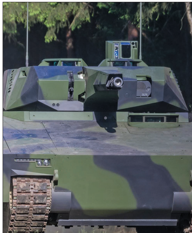
4. ábra. Lynx KF41, SEOSS stabilizált elektro-optikai érzékelőrendszerek a tornyon [16]
