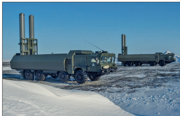
6. ábra. A Bastion-P rendszer a P-800-as hajó elleni rakétát alkalmazza, amely kis magasságon a tenger felett, nagy sebességgel (2,5 Mach) akár 300 km-es hatótávolságban is képes elérni célját [11]
