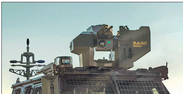
29. ábra. Az Aselsan vállalat SEDA lövésérzékelője, illetve SARP II távirányított tornya M2 12,7 × 99 mm-es nehéz géppuskával szerelve egy Ejder Yalçın tetőpáncélján [20]
