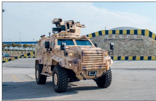
22. ábra. Páncéltörő rakétaindítóval szerelt Block 4. változatú Ejder Yalçın harcjármű a gyár teszt pályáján (Forrás: Nurol Makina)
