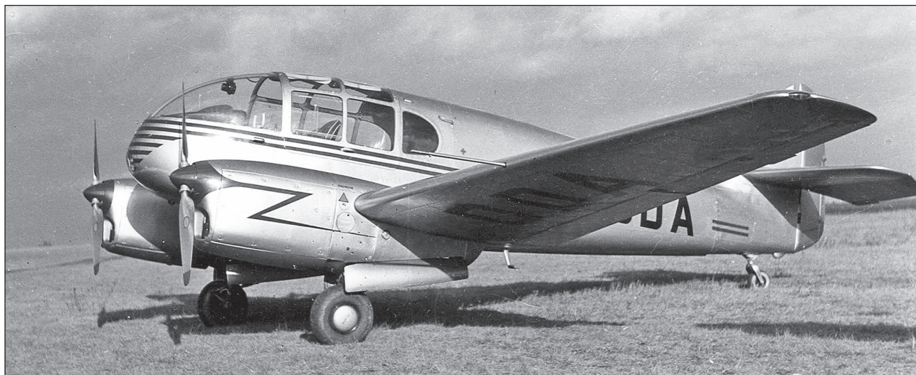
3. ábra. A 20. század első felében az Aero a katonai oktató-, bombázó- és vadászipülőgépek mellett polgári repülőgépeket is gyártott. Röviddel a 2. világháború után, az Aero bemutatta az Ae-45 légi taxit, amely 4 utast szállíthatott (Forrás: Aero Vodochody)
