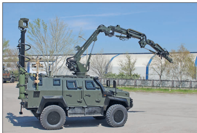
23. ábra. Az Ejder Yalçın Block 4+ harcjármű tűzszerész manipulátor karral, kitolható árbóca szerelt felderítő-kamerával és Aselsan SEDA lövésdetektáló rendszerrel felszerelt változata (Forrás: Nurol Makina)
