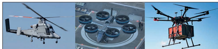
47. ábra. Tipikus nehéz, közepes és könnyű UAV-konstrukciók [15]
