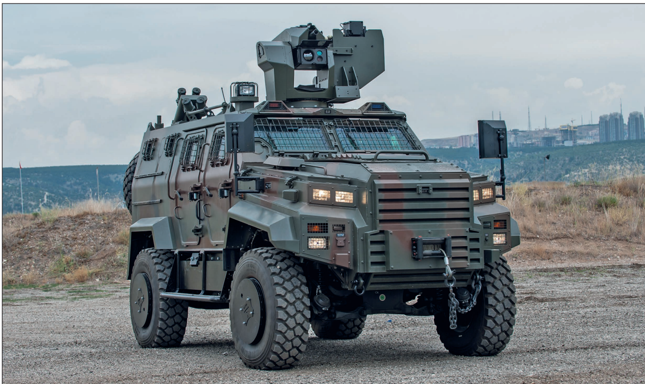
20. ábra. Az Ejder Yalçın Block 2. harcjármű egy változata az Aselsan vállalat gyártotta SARP típusú, távirányított toronnyal szerelve (Forrás: Nurol Makina)
