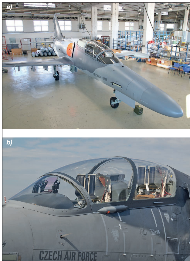
8. ábra. Kétüléses L-159 ALCA a szerelőműhelyben a). A pilótafülkét – a 4. generációs típusokra jellemző – két folyadékkristályos, színes képernyővel és néhány analóg műszerrel ellátott műszerfallal és széles látószögű Flight Vision FV-3000 HUD-dal szerelték fel b) (Fotók: Kelecsényi István)
