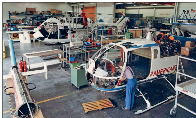
10. ábra. Az MBB BO 105 és BK 117 típusú helikopterek gyártása az USA mentőszolgálati számára, az 1990-es évek elején (Fotó: Airbus)
