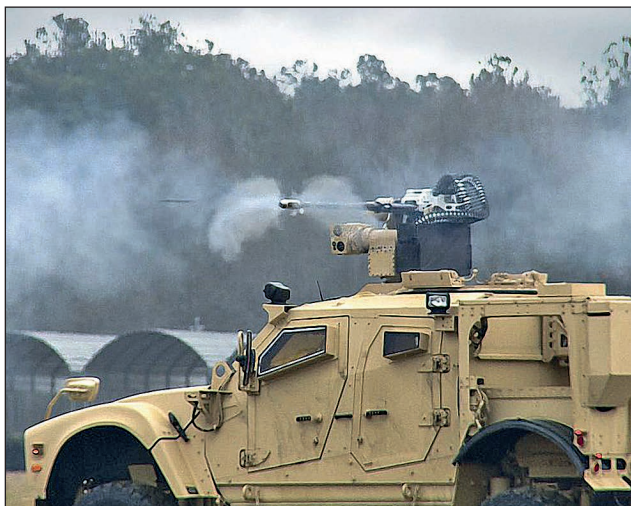
6. ábra. Az M230LF 30x113 mm-es löszert tüzelő géppágyúval szerelt M-ATV, tüzelés közben [11]
