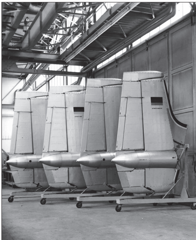
8. ábra. Nord Noratlas teherszállító repülőgépek összeszerelésre előkészített függőleges vezérsíkjai [2]
