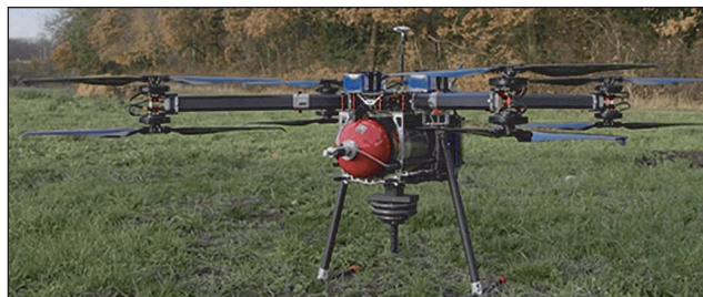
42. ábra. Rachel hidrogéncellával működtetett eVTOL októkopter drón [11]
