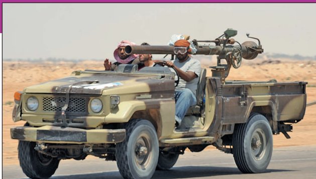
9. ábra. A másik közismert kialakítás: Toyota, 106 mm-es hátrasiklás nélküli löveggel [21]
