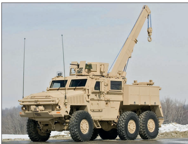
4. ábra. Az RG-33 6x6 hajtásképletű MRAP egy különleges, mentő-vontató kialakítású változata [9]
