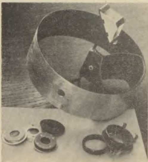
11. ábra. Segédtükör szerelése, Napmegfigyelésekhez szűrőüvegek foglalása.
