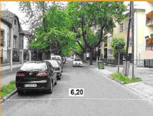
2. ábra: A 6 m körüli útszélesség problémái
