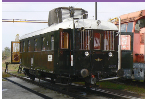
5. ábra: A Ganz-Jendrassik dízel motorokocsi
