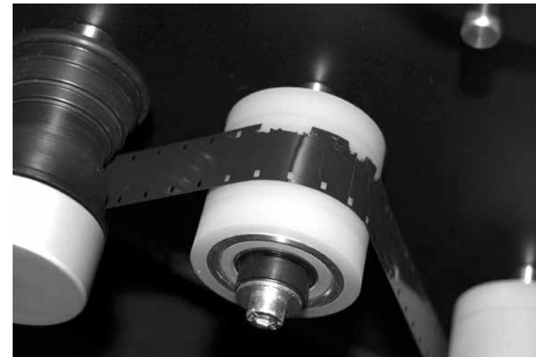
Sérült perforációjú 16 mm-es filmszalag a tisztítógörgőn
