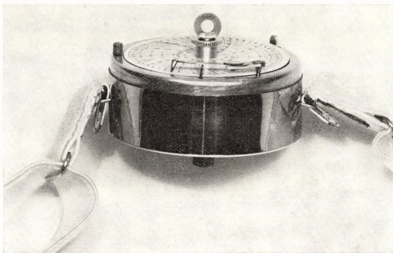
3. ábra. Lóránd-féle Mini-Tokograph (1968), fedél nélkül, tengelyében a felhúzó csavarral. 30 mm magas, 63 mm átmérő, 90 g. A minden eddigi típusnál kisebb méretei és nagyobb stabilitása teszi lehetővé a különböző testhelyzetben való alkalmazását (pl. terheseknél járkálás, gyermekágyasoknál szoptatás)
