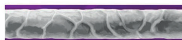
a gyapjúsál plazmakezelés után, a pikkelyek élei legömbölyítettek, nem kapcsolódnak össze a szomszédos szálak
