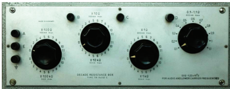
10. ábra. Finoman szabályozható ellenállásdekád 1,2 M \Omega -ig.
