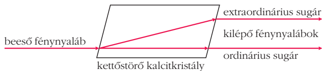
13. ábra. Sematikus rajz a kalcitkristály fénytöréséről.
