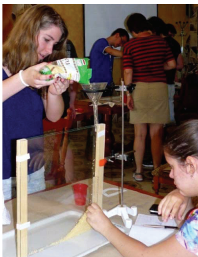
4. ábra. Tanulói mérések: granulált anyagok rézsűszögének mérése (balra) hidrosztatikai feketedoboz (jobbira).
