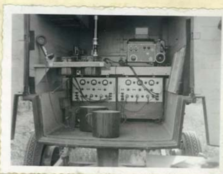
6. ábra. Oszcillográf és nagy erősítők. Előhívóberendezés.
