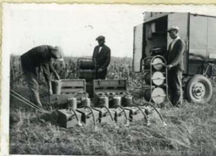
4. ábra. Felvevőkészülékek, előerősítők és kábeldobok.
