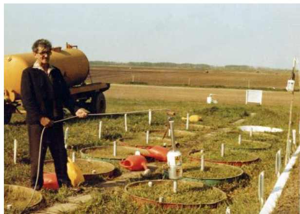
1. kép. Liziméteres kísérletekkel vizsgálták a talajok szennyvíztisztító képességét Kecskeméten (Fotó: Vértési L.)
