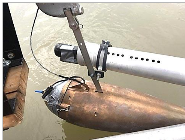
5. ábra. A LISST-ABS zavarosságmérő szonda rögzítve a US P-61-A1 izokinetikus mintavevőn Figure 5. The LISST-ABS sensor adjusted to the US P-61-A1 isokinetic sampler
