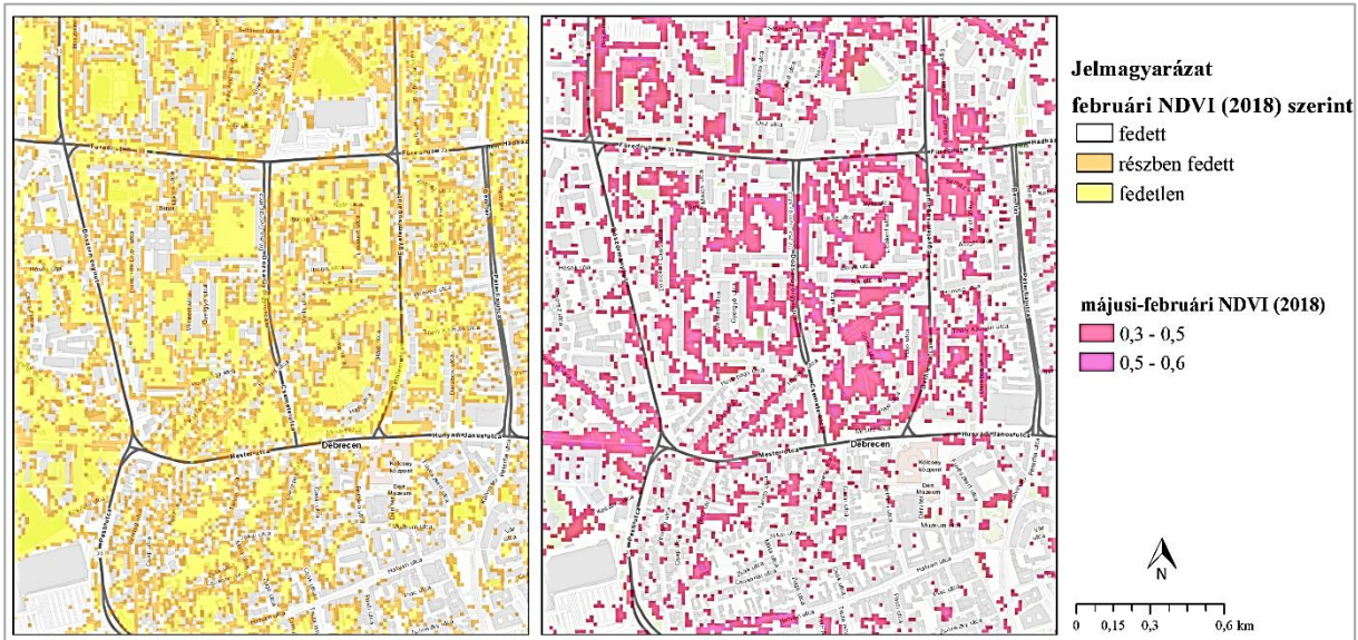
4. ábra. A fedett, részben fedett és fedetlen városi területek meghatározása 2018 februári NDVI értékek alapján, valamint a májusi és februári NDVI értékek különbség-térképe Debrecen belvárosának ÉNY-i részén
