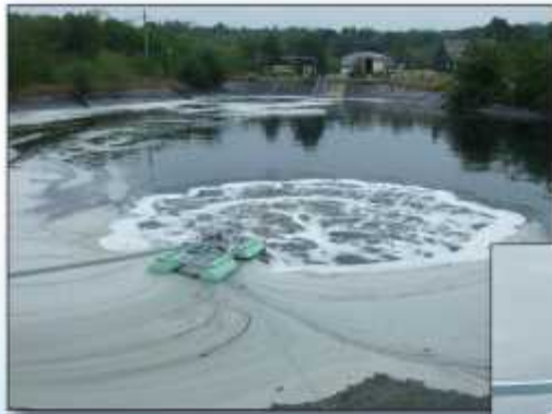
Berendezések tavak levegőztetéséhez, eutrofizáció és kellemetlen szagok csökkentéséhez vagy megszüntetéséhez
