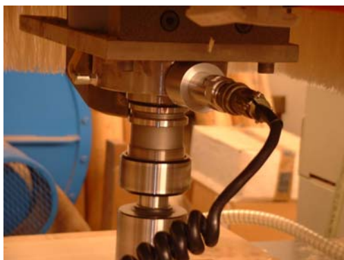
4. ábra – A gyorsulásérzékelő rögzítése a szerszámtengely csapágyazásán
