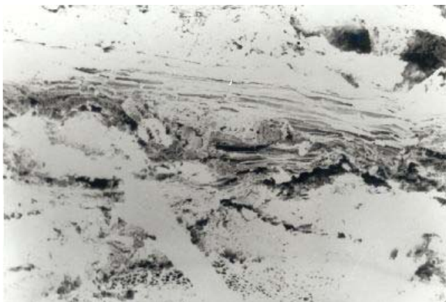
5. ábra – Bison gipszkötésű forgácslap. Nagyítás: 70x (Takáts 1995)
