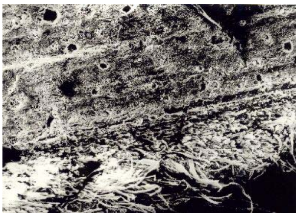
3. ábra – Gipszkarton lap élfelülete. Nagyítás: 70x (Takáts 1993)
