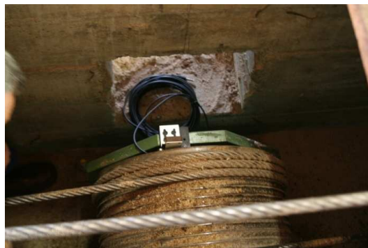
1. ábra – A rönkkocsi előtolási sebességének mérése
