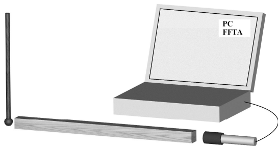
2. ábra – A próbatest longitudinális frekvenciájának meghatározása
