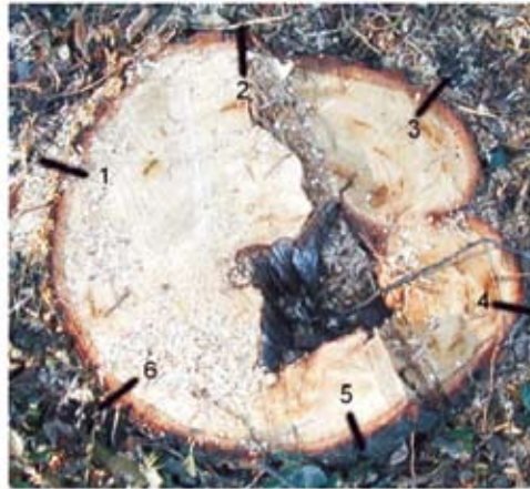
6. ábra: A relatív vonalsebesség csökkenésén alapuló eljárással kimutatott üreg.
