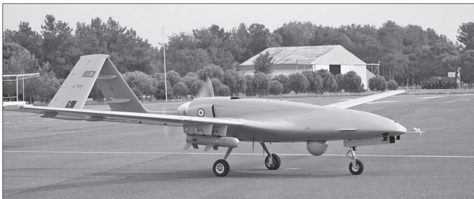
2. kép Egy török gyártmányú Bayraktar TB2 típusú UAV MAM-L rakétákkal felfegyverzve 24
