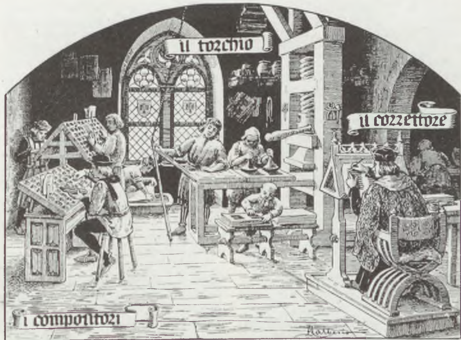
Nyomdászattörténeti vonatkozású torinói falfestmény. Ez a kép a szedőket, a nyomtatómunkásokat meg a korrektort ábrázolja munkaközben. A szedők egyike ülve dolgozik. A terjedelmes, a terem boltozatához odapöckölt faszajton ketten dolgoznak, mégpedig fölvaltva: az egyik festékezi a formát, a másik pedig punktúrára rakja az ívet s leereszti a sajtófordót. A háttérben az egyik munkás a papírosíveket nyirkosítja a földre helyezett teknőben, a prés előtt pedig egy kis gyerek amatőrösködik, egymásra rakva a sajtóból kikerült íveket. (Gyermekmunka ismeretlen valami volt a régi könyvnyomtatók világában.) Jobbfelől, az előtérben dolgozik a nyomda esze, a korrektor, díszes palástban, barettal a fején. A korrektorság akkoriban a legelőkelőbb foglalatosságok közé számított.
