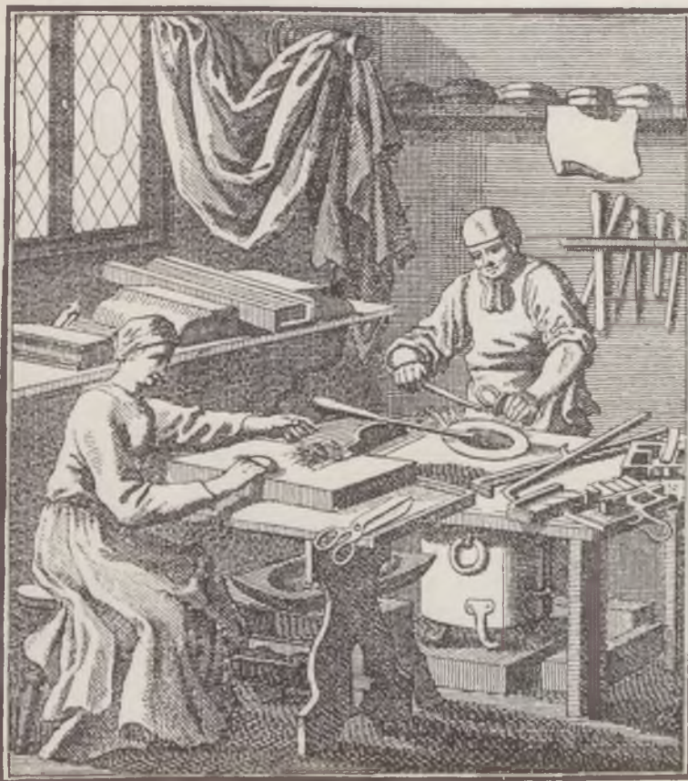
Betűöntő-műhely a tizenhatodik századtól a tizenkilencedik század közepéig. Úgynevezett kéziműszerrel történt az öntés jó négyszáz esztendeig, amíg ugyanis az amerikai Bruce Dávid föl nem találta az első, a gyakorlatban is jó eredménnyel használható betűöntőgépet.
