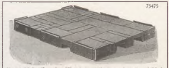
Kvartoldal: 4 sarok-, 2 közepszorítókapoccsal és ürpótlókkal.
