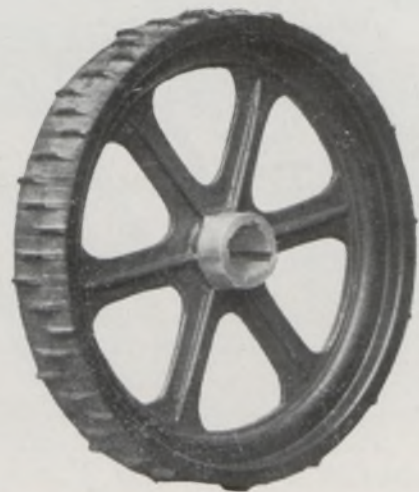
2. ábra. Az ívberakást eszközölő alumínium-fogaskerék. (Előresimítő tárcsa)
