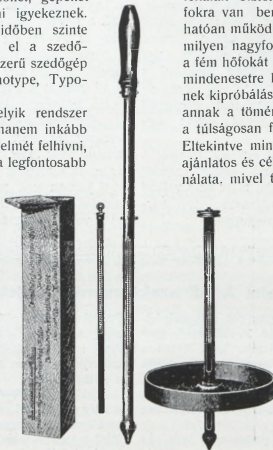
I. Védőszekrény a hőmérőhöz. — II. Hőmérő 300 C.-fokig. — III. Nagy olvasztóüst hőfokának megállapítására szolgáló vesszőformájú hőmérő. — IV. Bármely üstben alkalmazható tányérformájú hőmérő.
