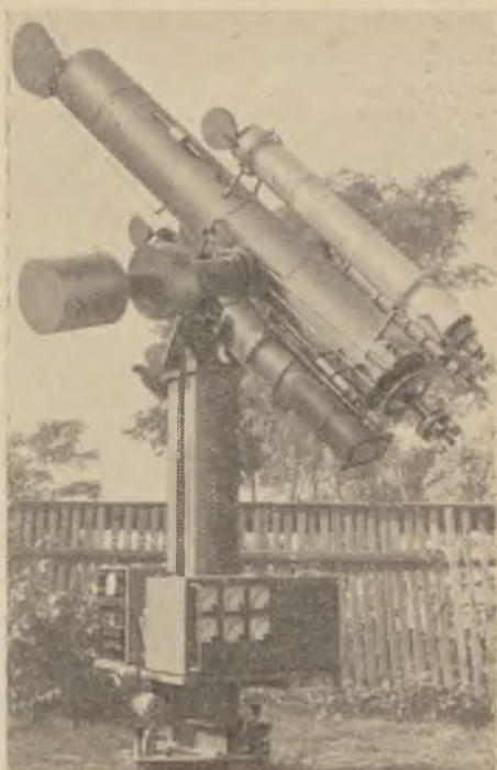
8. ábra. Debreceni Istrán ciklotai amatőr-csillagász 320 mm átmérőjű Cassegrain távcsőre, 150 mm-es Cassegrain követő, és 80 cm-es keresőkkel, F : 1,5-os fotokamarával, óraművel
