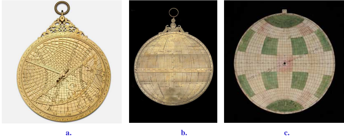
2. ábra. a. A Gemma Frisius-féle univerzális asztrolábium; b. A Juan de Rojas-féle univerzális asztrolábium; c. A Philippe de la Hire-féle univerzális asztrolábium
