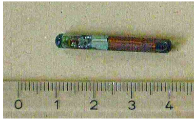
2. ábra: Állatokba implantálható (injektálható) passzív kivitel
