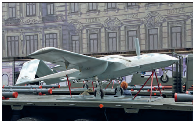
75. ábra. Korszar pilóta nélküli repülőgép. A szállítójárműve platóján az Ataka irányított páncéltörő rakéták indítókonténerai is láthatók
