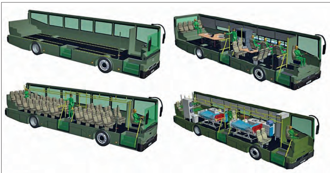
7. ábra. A CURRUS ARIES 01 Busz előtanulmányainak számítógépes grafikája jól szemlélteti a moduláris rendszert. Bal alsó képtől az óramutató járásával megegyezően haladva: személyszállító, az alapplatform, törzsbusz és végül sebesültszállító elrendezés
