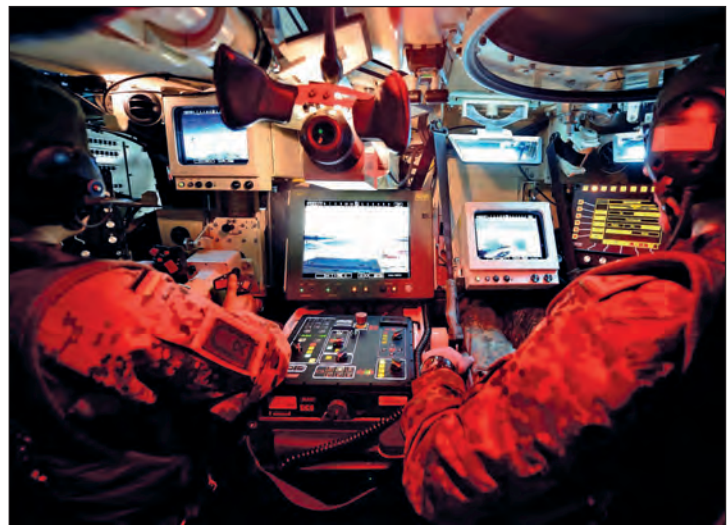
25. ábra. Az irányzó (bal oldal) és a parancsnoki (jobb oldal) SBG-k és a közöttük lévő ZBG-egység
