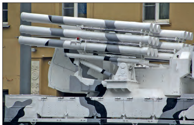
86. ábra. A Pancir-SzA rakétaindító blokkjai. A gépágyú helyett blokkonként 3 db rakétával több került a fegyverzetre, 2-2 oldalon 3×3-as elrendezésben
