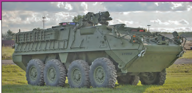
20. ábra. Kiegészítő ballisztikai védőelemekkel felszerelt Stryker ICV DVH jármű [16]
