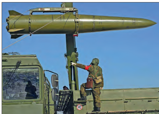
32. ábra. A képen az Iskander rakéta látható. A rakéta minimális hatótávolsága 50 km, a maximális – típustól függően – 480-490 km (max. 500 km). A rakéta indulótömege 480 kg (indítóállvánnyal együtt 42 300 kg). Rakétahajtómű (szilárd hajtóanyagú) RDTT. A robbanófej fajtái: kazettás, páncéltörő és nagy hatóerejű. A vezérlőrendszer fajtái: inerciális autonóm, komplexált optikai önrávezetési fejjel. Az alváz típusa kerekes. A rakéta mennyisége szállító járműben 2 db, indítóállványon 2 db. Személyzete 3 fő. A rakéta szolgálati ideje 10 év. A rakéta -50^{\circ}\text{C} – +50^{\circ}\text{C} hőmérséklet-tartományban működőképes
