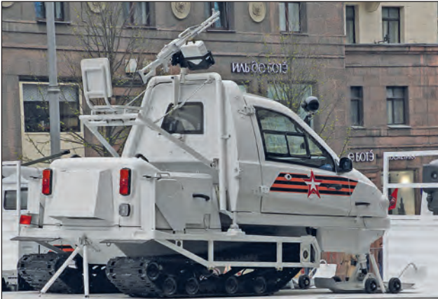
80. ábra. TTM-1901-40 Berkut-2 bukókeretre rögzített „küzdőtere” a 7,62 mm-es 6P41 PKP géppuskával
