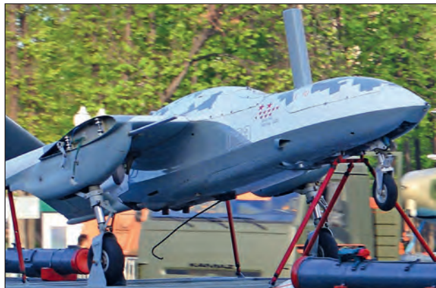
76. ábra. Korszar UAV szállítási helyzetben. A gép oldalán csillagok jelölik a sikeres harci bevetések számát
