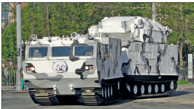
83. ábra. Tor-M2DT sarkköri légvédelmi rakétakomplexum fordulás közben, a díszszemlére készült speciális festéssel. Különösen széles láncaltalpai kiváló terepjáró-képességet biztosítanak a harcjárműnek
