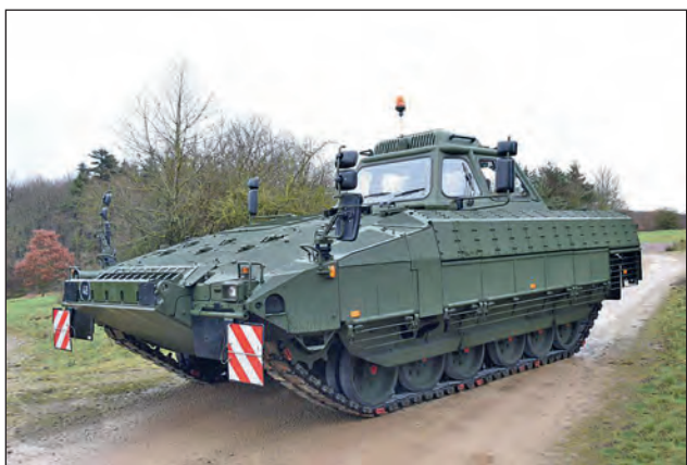
29. ábra. A Puma alvázára épített harcjárművezető- oktatójármű
