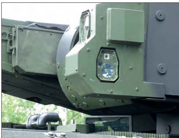
26. ábra. A torony bal oldalán lévő előre- és oldalra néző MUSS érzékelők elhelyezkedése
