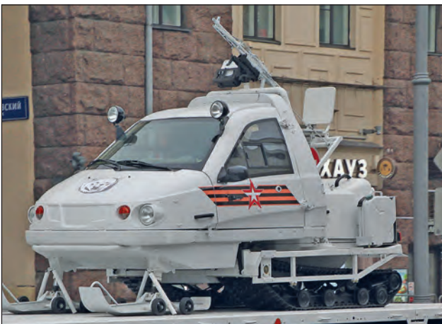
81. ábra. TTM-1901-40 Berkut-2 fűthető kabinnal rendelkező motoros szán. A járműajtók 180°-os szögben kihajthatók
