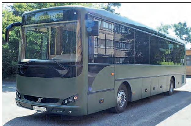
8. ábra. Az MH LK KFTSZO tanulmányának gyakorlati megvalósulása a HM Currus Zrt. tervei szerint. Az EURO 5-ös motorral szerelt technológiai demonstrátor, amelyen gyakorlatban is kipróbálták a moduláris rendszer berendezéseit
