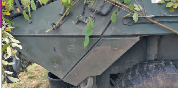
19. ábra. Csavarkötéssel felszerelt kiegészítő ballisztikai védelemek egy Stryker járművön 24 (Fotó: a szerző saját felvétele)
