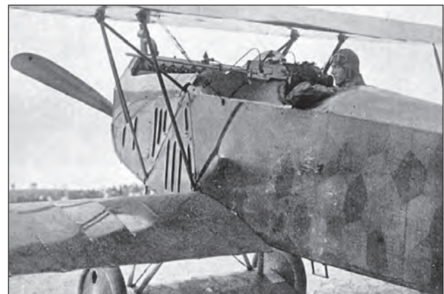
11. ábra. A csehszlovák tulajdonba került 3867-es számú MÁG-motoros schwerini D.VII-es. Jól látható a kései gyártású Fokker tereptarka mintázata, a motorburkoló lemezek és a Schwarzlose géppuska (vinar.cz)
