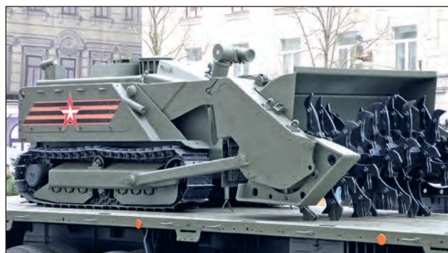
66. ábra. Az Uran-6 távirányítással aknamentesítő harcjármű. A jármű elején látható a forgó aknafelszedő/megsemmisítő szerszám. A pajzs fölött a két síkban elforgatható kamera látható
