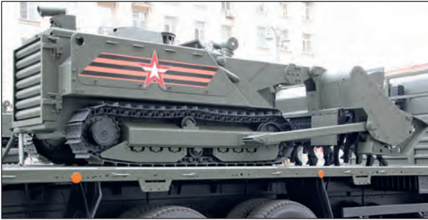
67. ábra. Az Uran-6 távirányítású aknamestesítő harcjármű hátulnézetből
