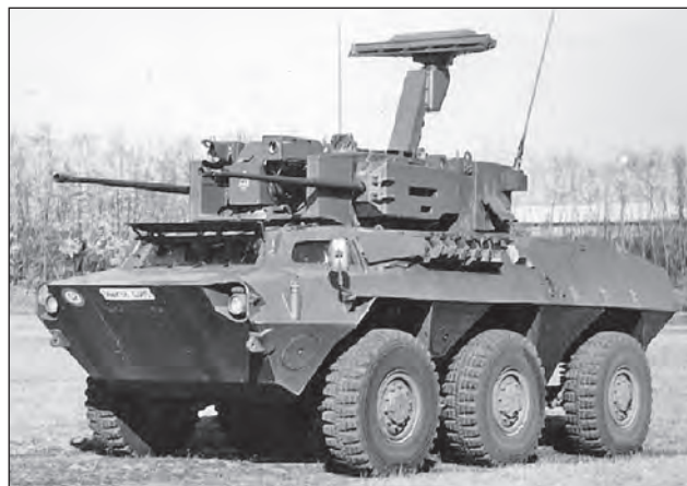
17. ábra. A német Wildcat önjáró légvédelmi gépágyú prototípusa az ikercsövű Mauser MK30-2 gépágyúkkal
