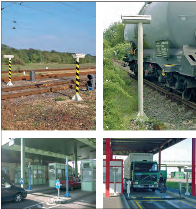
5. ábra. Határállomáson működő sugárkapuk [3]
