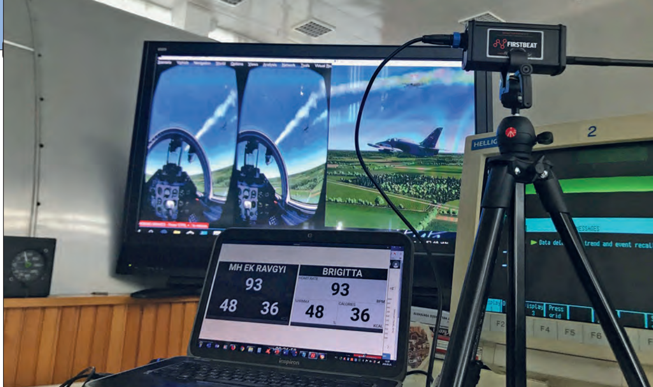
1. ábra. Nagy képernyőn követhetők a tesztrepülést végző hajózó személyzet által látott szimulált repülési feladatok virtuális és más speciális nézetei. Előtérben az aktuális élettani paramétereket rögzítő Firstbeat antenna, és a személyzet valós idejű fiziológiai értékeit továbbító és megjelenítő hordozható terminál
