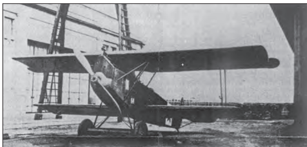
7. ábra. Archív fotó a Mátyásföldön álló schwerini D.VII-esről. A gép függőleges vezérsíkján alig észrevehető a vörös csillag jelzés. A gépeket a gyár kései, 4 színű (alul más árnyalatú) Fokker álcázó festésével szállították a hadseregnek
