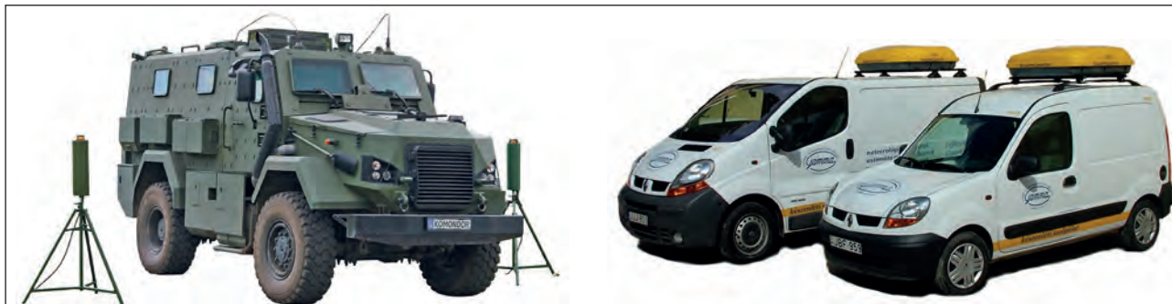
9. ábra. Mobil sugárkapu és járműfedélzeti sugárkapuk [3]
