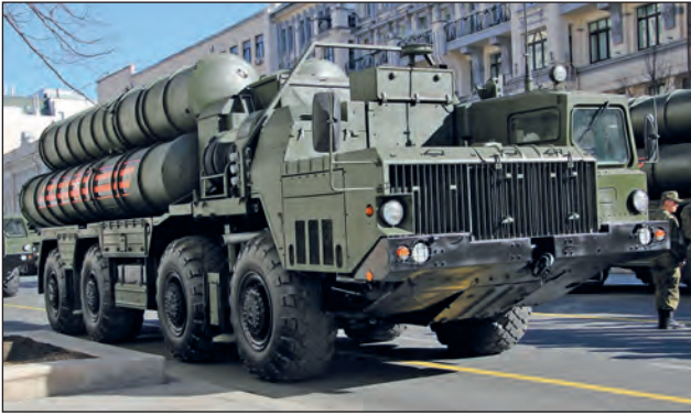
63. ábra. Az Sz-400 légvédelmi rakétarendszer harci járműve a rendszerhez adaptált nyolckerék-meghajtású MAZ-543M
