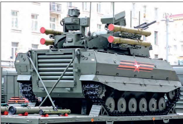
68. ábra. Az Uran-9 személyzet nélküli harcjármű (UCGV) hátulnézetből. Két oldalán 2-2 db 120 mm-es 9M120 Ataka irányított páncéltörő rakétával, a platón pedig a további fegyverzet látható, jobb oldalt a Shmel-M rakétavető
