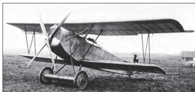
2. ábra. A Monarchia kívánalmai alapján épített V.22/D.VII-es a schwerini repülőtéren. Jól látható, hogy a gép oldalkormányát egy másik repülőről szerelték át, ebben az esetben a V.21-esről, ami a németek számára épített harmadik D.VII-es prototípus volt (Fotó: airwar.ru)
