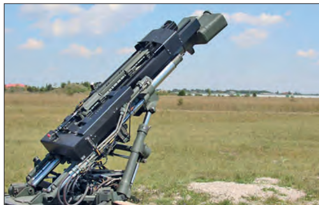
3. ábra. Tűzelőállásban a Hirtenger SRAMS Mk II félautomata 120 mm-es nehéz aknavetője [7]
