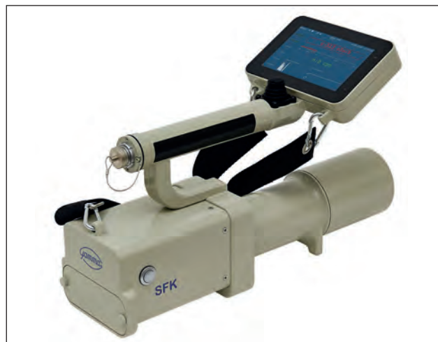
12. ábra. Sugárforrás-kereső és izotópazonosító műszer [3]
