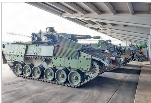
15. ábra. A Puma harcjármű részlegesen leszerelt oldalpáncéllal
