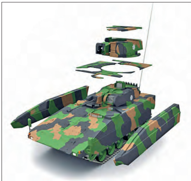
13. ábra. A Puma harcjármű páncélzatának felépítése
