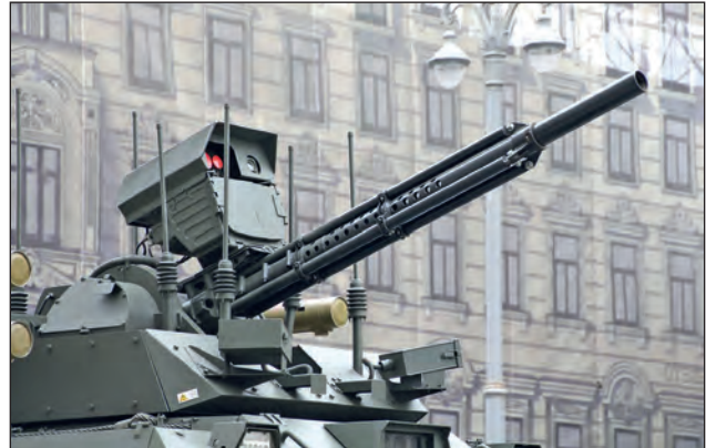
69. ábra. Az Uran-9 a 30 mm-es 2A72 géppágyúval és tőle jobbra a párhuzamosított 7,62 PKTM géppuskával. A géppágyú fölött láthatók az irányzórendszer elektrooptikai elemei
