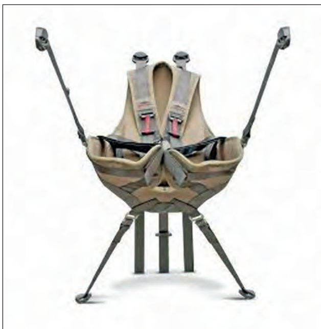
14. ábra. Az Autoflug GmbH által a Puma harcjármű számára gyártott vezetőülés, és annak állállítható hevederei
