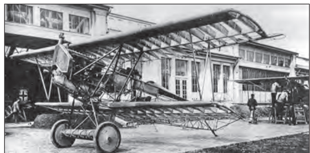
5. ábra. Az első MÁG építésű D.VII-es, a 93.01-es váza. Jól látható az acélcsőrács-szerkezetű törzs és a vastag profilú szárnybordázat (Winkler Aero Archív)
