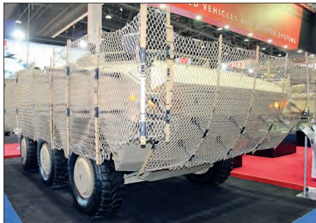
15. ábra. Az FNSS Pars 6x6 harcjarmúre szerelt Tarian védőelem [15]
