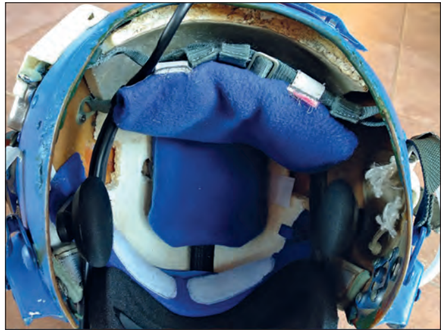
4. ábra. A pilóták agyi homloklebenyének oxigén-telítettségét és a légzési jellemzőket rögzítő műszereket, valamint a virtuálisvalóság-szemüveget integráló sisak prototípusa
