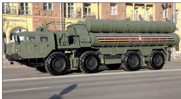
62. ábra. Az Sz-400 nagy hatótávolságú önjáró légvédelmi rakétarendszer 5P85SM2-01 rakétaindító járműve a 4 db légvédelmi rakétával
