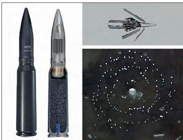
20. ábra. A KETF-lőszer, annak metszete és repeszeinek szórásképe
