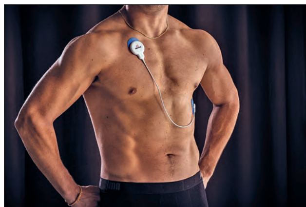
2. ábra. A Firstbeat Technologies folyamatos (több napos) élelteni monitorozást támogató testszenzor készüléke (Bodyguard2)
