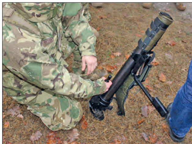
1. ábra. A Hirtenberger új terméke a cég által kifejlesztett M6C–210 Commando típusú, 60 mm-es könnyű aknavető [9]
