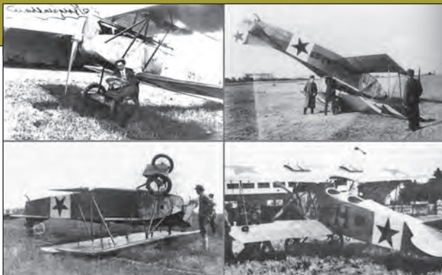
6. ábra. Különböző vörös csillagos Fokkerek: a 93.03 (?) motorburkoló lemez nélkül, a 93.07 és a 93.09 átbukva, és a négyágú légcsavarral felszerelt H.08-as, felső szárnyán a négy áramvonalas kiegészítő benzintartállyal (Fotó: airwar.ru)
