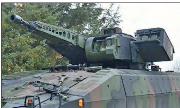
23. ábra. A Puma tornyának bal oldalára integrált MELS rendszer
