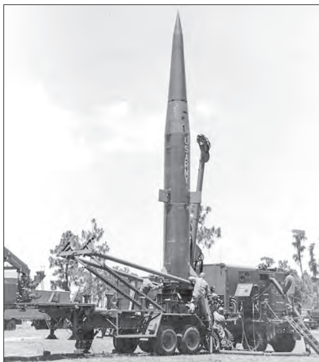
6. ábra. A képen szintén egy Pershing 2 közepes hatótávú (hadműveleti) ballisztikus rakéta látható. Technikai jellemzői: hosszúsága 10,61 m, átmérője 1,02 m indításra kész tömege 7400 kg. W-85-ös típusú robbanófejjel rendelkezett, amely csapásmérésének hatóerejét 5 és 80 kt között lehetett szabályozni. A rakéta hatótávolsága körülbelül 1700 km volt. Önjáró szállító-indító járműre, vagy vontatott félpótkocsira telepítették
