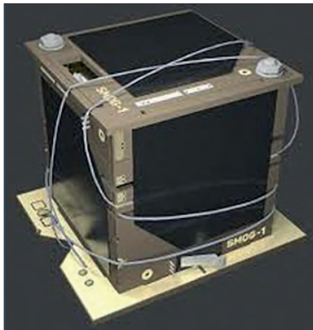
3. ábra. A SMOG-1, az 5 cm-es kocka behajtott antennával. Vele azonos méretű a SMOG-P
