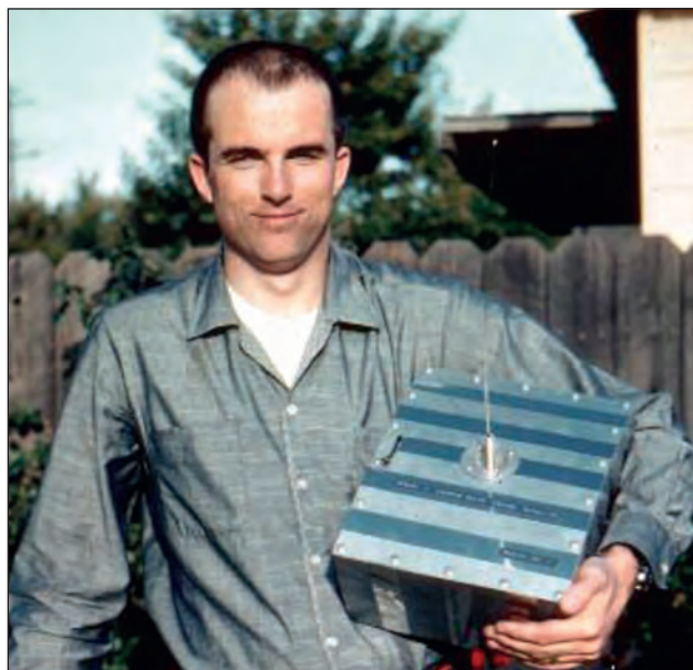
2. ábra. Az OSCAR-1, az első, rádióamatőrök által készített műhold
