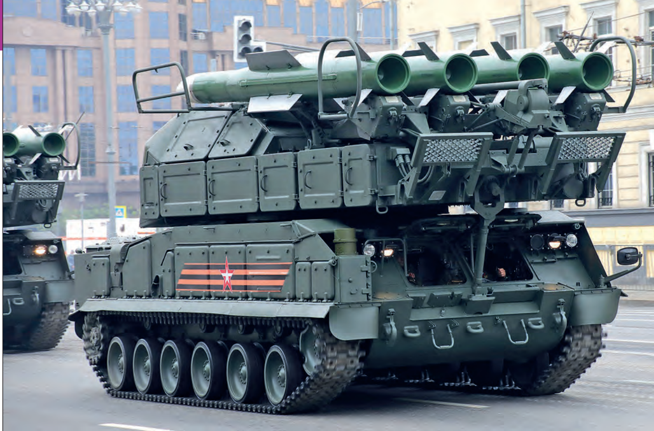
55. ábra. A 9K317 Buk-M2 közepes hatótávolságú lánctalpas légvédelmi rakétakomplexum 9A317 harcjárműve, négy harcra kész rakétával (jobb oldali nézet)
