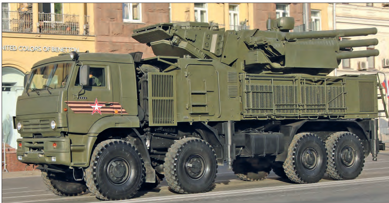
59. ábra. A 96K6 Pancir-Sz légvédelmi rakéta- és géppágyúkomplexum a Kamaz 6560 Tornádó alvázon látható, az új típusú felderítő lokátorral
