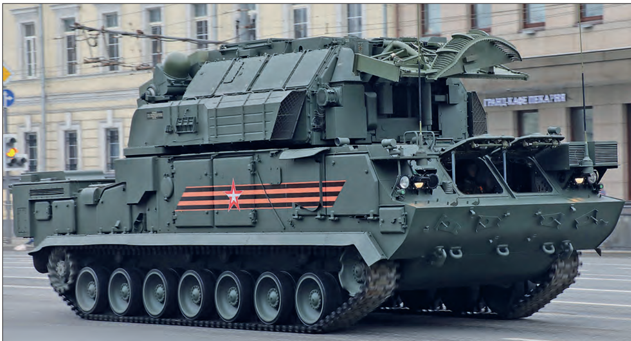
57. ábra. A 9K332 Tor-M2U rövid hatótávolságú lánctalpas légvédelmi rakétakomplexum 9A331M harcjárműve a hét futógörgős GM-5955 alvázon (jobb oldali nézet)
