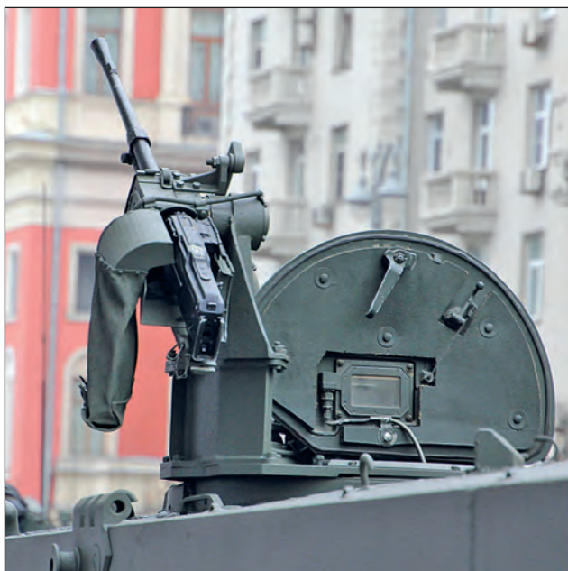
51. ábra. BTR-MDM Rakuska fő fegyverzete a távirányítású 7,62 mm-es 6P7K PKMT géppuska
