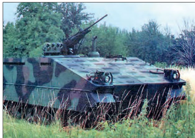
7. ábra. Egy 12,7 mm-es főfegyverrel szerelt TH 495-es láncalpas harcjármű
