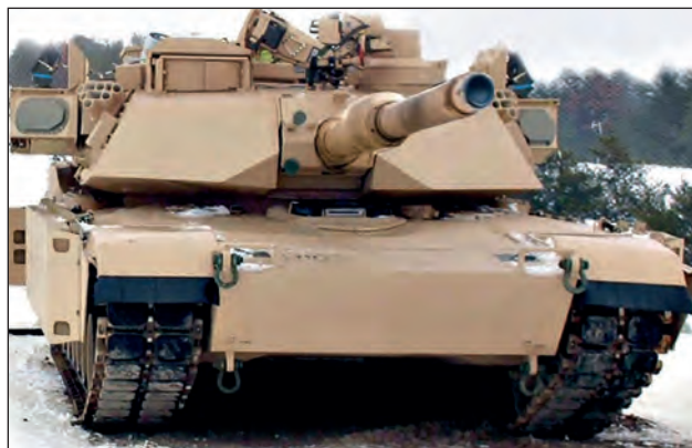
4. ábra. Trophy aktív védelmi rendszerrel felszerelt M1A2 Abrams változat. A harckocsitorony bal és jobb oldalán jól látható egy-egy nyolcszögletű, repeszvédett radarantenna, mögötte egy-egy repesztöltet-kivető egység
