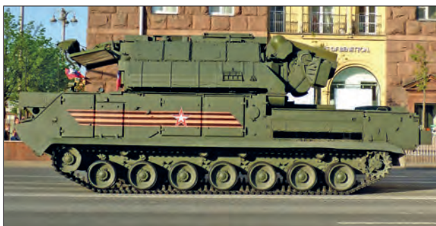
58. ábra. A 9K332 Tor-M2U légvédelmi rakétakomplexum bal oldali képe. Elöl a célfelderítő, hátul a tűzvezető lokátorok láthatók menethelyzetben
