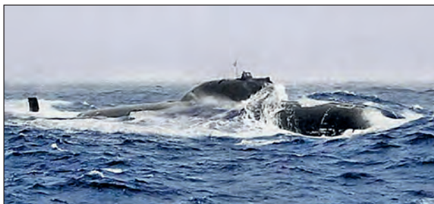
21. ábra. Kellemetlen időjárási viszonyok között szükség volt a szélvédőre a kicsi, alacsony Projekt 705-ösökön, noha a felszínen csak kb. 12 csomóra volt képes a típus
