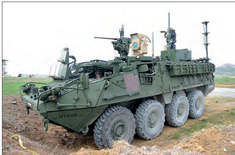
8. ábra. A Multi-Domain Task Force részét képező légi szállítható Stryker harcjármű lézerfegyverrel felszerelve
