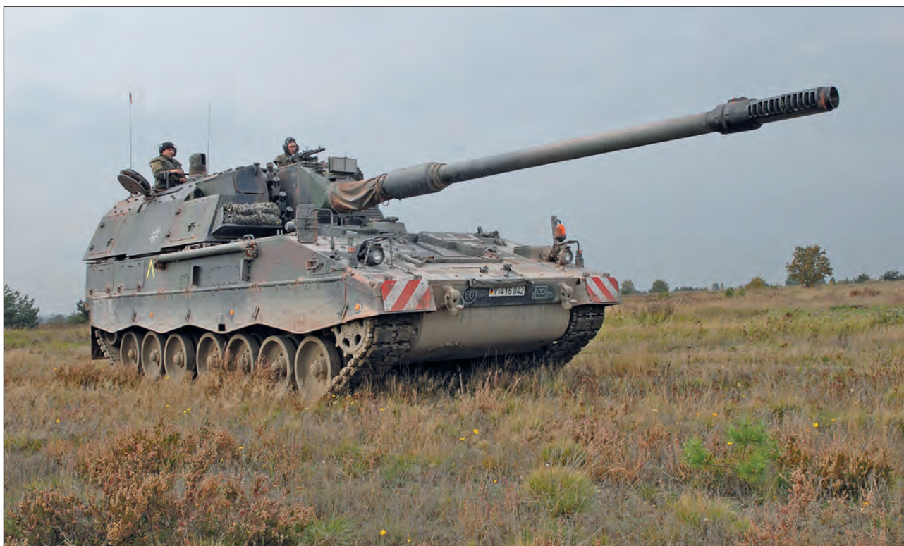
4. ábra. A Bundeswehr egyik PzH 2000-ese menetben, impozáns látvány a jármű fő fegyvere, a 155 mm űrméretű, 52 kaliber hosszúságú, csőszájfékkel ellátott lövegcső (Fotó: KMW)
