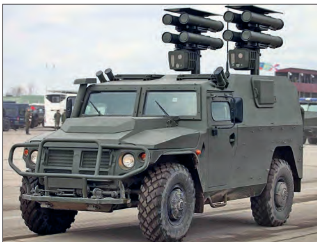
9. ábra. Oroszország egyik legújabb 9M133M Kornet-M „önjáró” páncéltörőrakéta-indító rendszere
