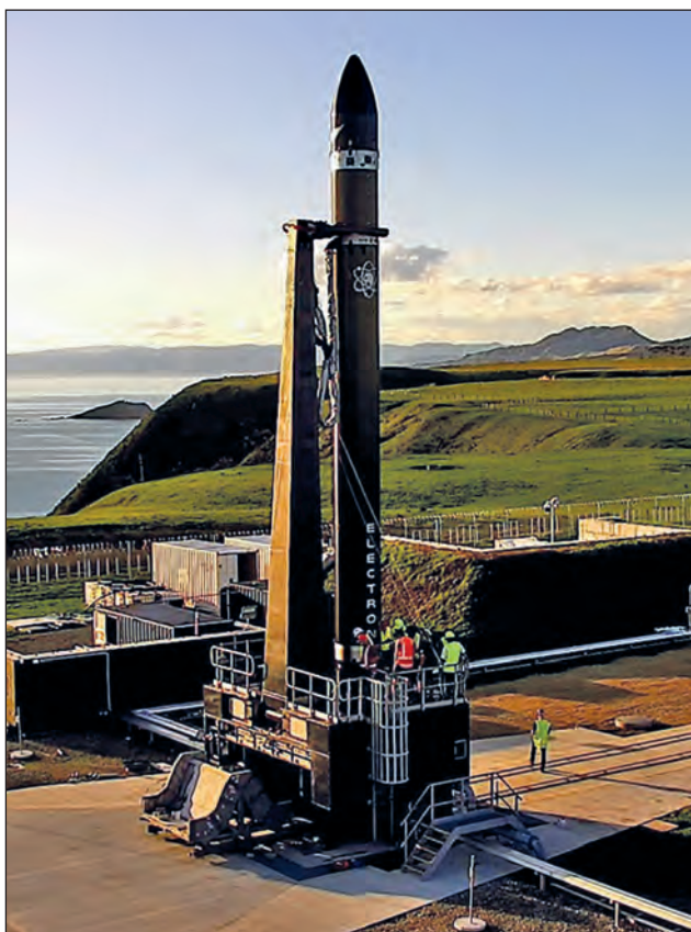
5. ábra. A SMOG-P-t pályára állító, 17 m magas Electron rakéta az új-zélandi starthelyen
