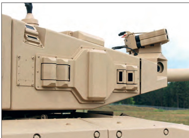
8. ábra. A Rheinmetall cég Leopard 2A7 toronyra szerelt 500 µs reakcióidejű, elektro-optikai érzékelős AMAP-ADS aktív védelmi rendszere
