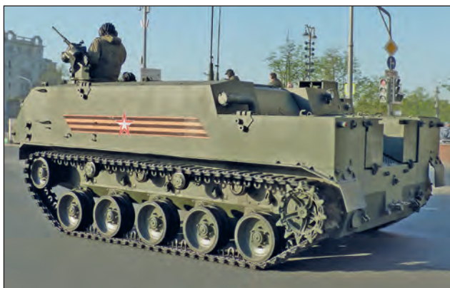
50. ábra. BTR-MDM Rakuska légideszant csapatszallító harcjármű hátulról. A hátsó vízszintes felületek az ejtőernyő-kötegek tárolóhelye
