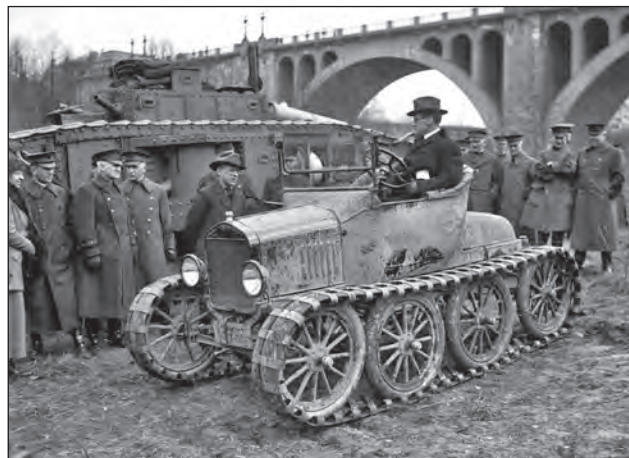
1. ábra. T-modell hernyótalpas használatra alakítva, eredeti futóművekkel (Forrás: Library of Congress)
