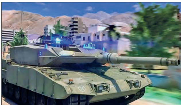
7. ábra. Trophy aktív védelmi rendszerrel felszerelt Leopard 2A7 harckocsi látványképe. A harckocsitorony első részén jól látható a nyolcszögletű, repesz ellen védett radarantenna
