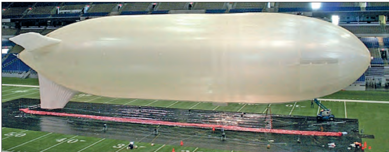
5. ábra. A nagy magasságú kommunikációs léghajók – mint az amerikai HiSentinel 80 – a műholdhálózat képességeit hivatottak kiegészíteni, vagy szükség esetén pótolni
