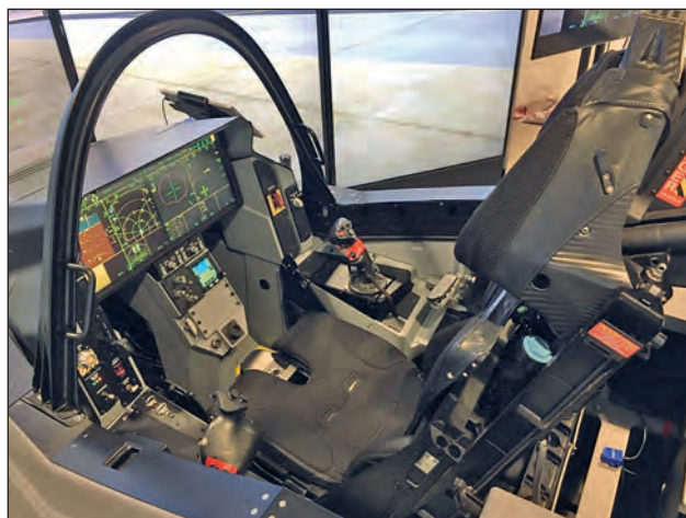
7. ábra. A konferencián bemutatott az F-35-ös harci gép szimulátorának pilótafülkéje (Fotó: H. S.)
