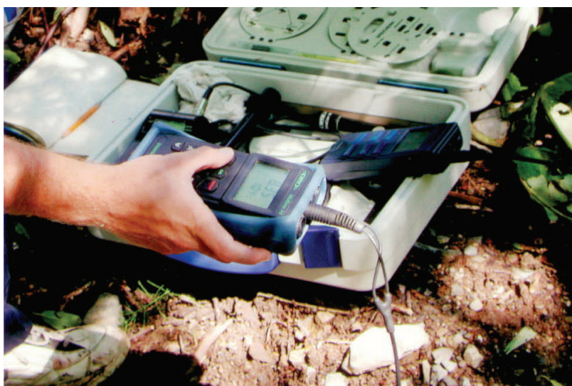
14. ábra. Fajlagos elektromos vezetőképességmérő (Cond 315i/SET és Tetra con R 325
