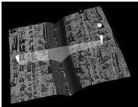
10. ábra. A 2 MHz ismétlési frekvenciájú, 30 \mu\text{J} impulzusenergiájú lézersugárral készült szublimációs árok fénymikroszkópi képe
