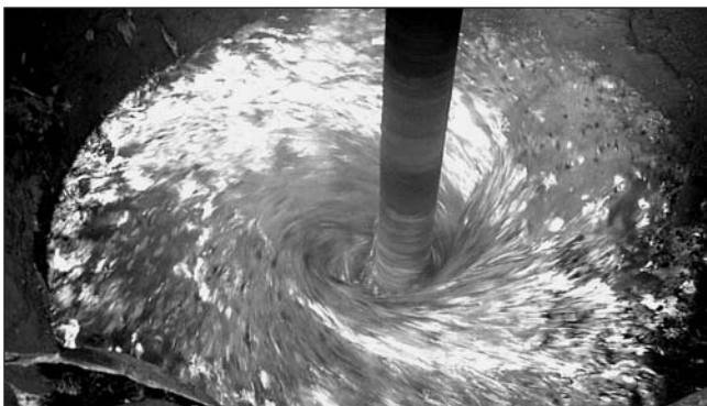
■ 3. ábra. A nyomásos öntődében alkalmazott sóadagolásos üstkezelés közben kialakuló olvadékfelszín
