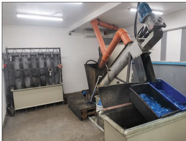
■ 5. kép. Röntgenfilm-feldolgozás során alkalmazott technológia pilot-plan modellje
