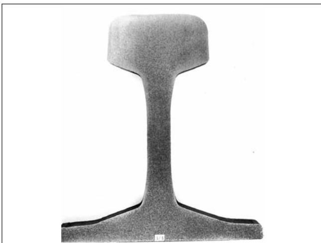
■ 6. ábra. UIC 60 rendszerű, 900A minőségű hengerelt sín makrociszolat fényképe [9]
