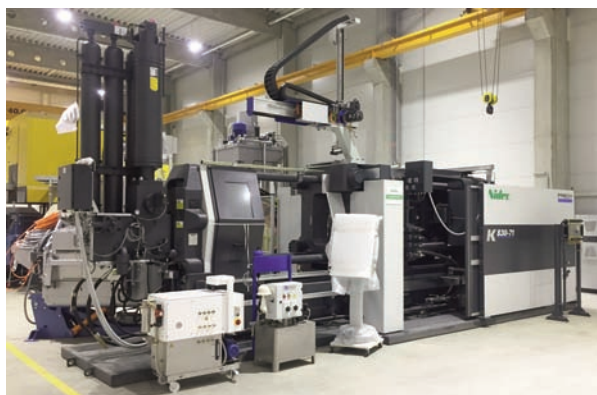
FRECH gyártmányú nyomásos öntőgép és komplett cella telepítése
