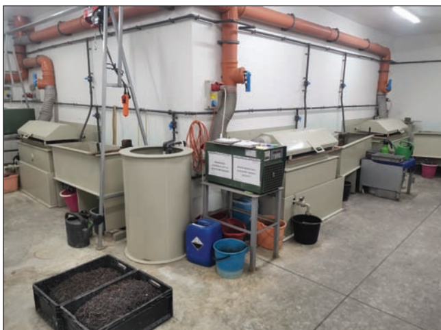
■ 3. kép. Nemesfém bevonat visszanyerésére alkalmas elektrokémiai rendszer
