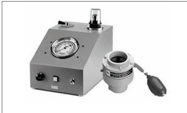
■ 1. ábra. DISA-típusú elektromos gázáteresztőképesség-mérő berendezés, mellette a homokmagok befogására szolgáló felfújható bélésű hüvely
