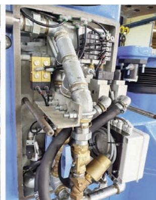
Foromat 40 formázógép teljes körű felújítása, PLC-s vezérléssel, kétkezes indítással
