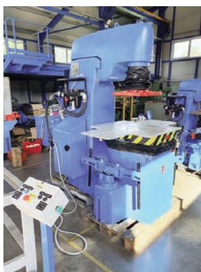
Foromat 40 formázógép teljes körű felújítása, PLC-s vezérléssel, kétkezes indítással
