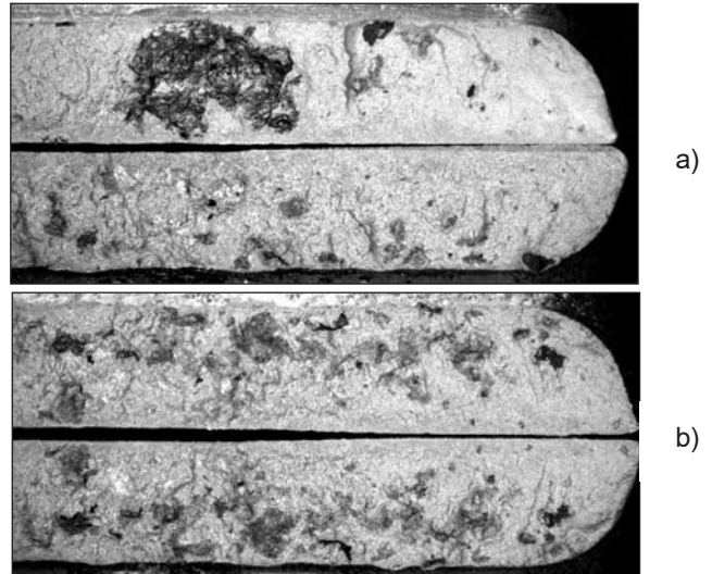
5. ábra. Az üzemi (a) és dupla oxid (b) technológiával öntött K-mold próbatestek törési felületéről készített sztereomikroszkópos felvételek
