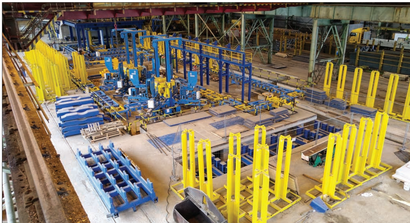
■ 3. kép. A kötözőprések és a tekercsmozgató pálya a legkorszerűbb svéd technológia alkalmazásával (telepítés közben)
