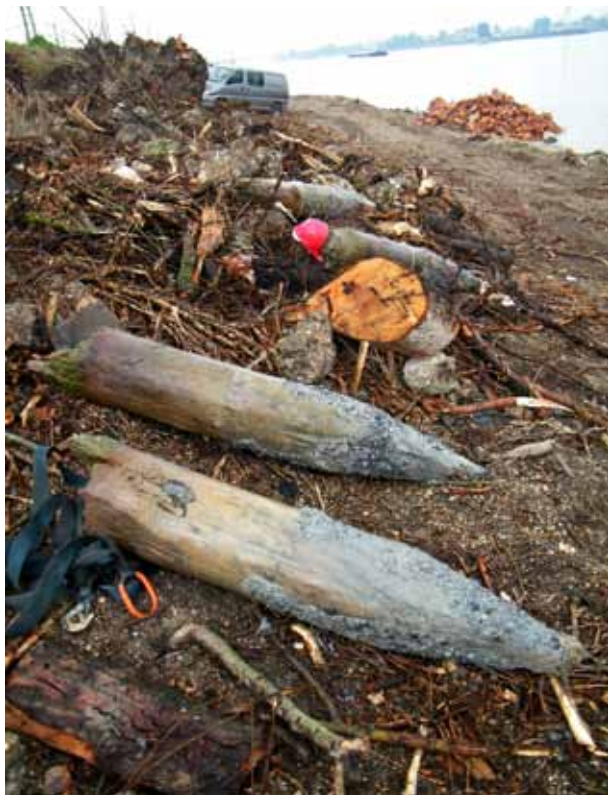
4. kép A 2014-ben kiemelt cölöpelemek a parton
