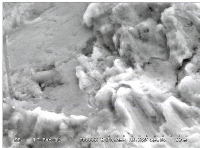
3b. ábra. Bionika CorticalL implantátum EM képe
