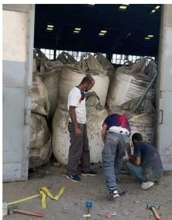
A nyitott raktárjátó, belül a nagyméretű Big-Bag zsákokban a betárolt ammónium-nitrát
