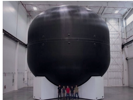
10. ábra. Gigantikus szénszálás és grafittal kombinált gömb, űrhajó tüzelőanyagának tárolására
