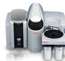
iCE 3000 AA család Innovatív dizájn, automatikus váltás a láng és grafitkernye üzem módok között
