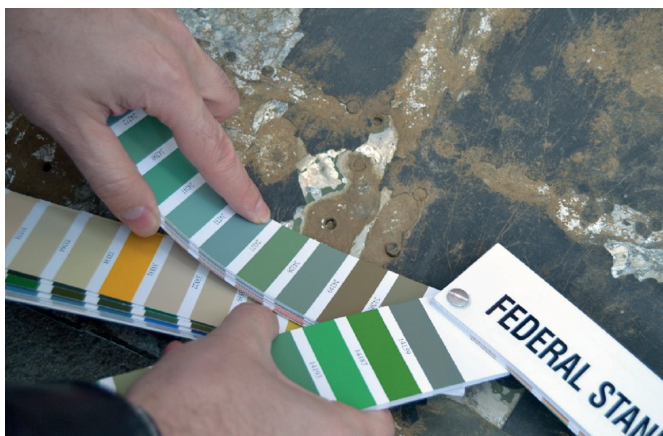
3. ábra. A spektrofotométeres vizsgálattal párhuzamosan színkártyás színárnyalat-azonosítás is készült (hivatalos Federal Standard FS-595C színkártya-szettel), különböző roncsdarabokon (kizárólag hozzávetőleges színhasonlóság megállapítása végett)
