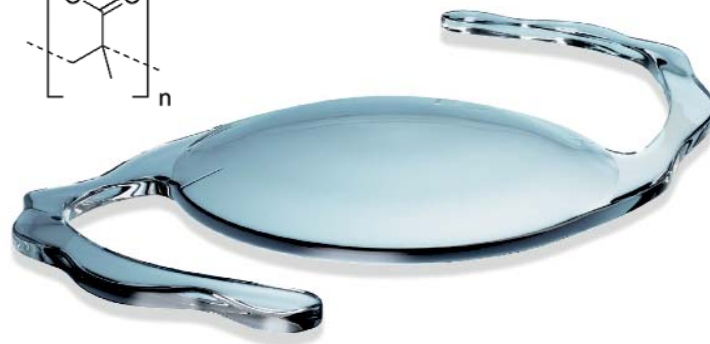
4. ábra. Egy intraokuláris lencse (IOL) képe. A lencse optikai átmérője 6, a teljes méret 13 mm, az oldalsó ívek a lencse szembe rögzítésére szolgálnak ( https://www.hines-sight.com )
