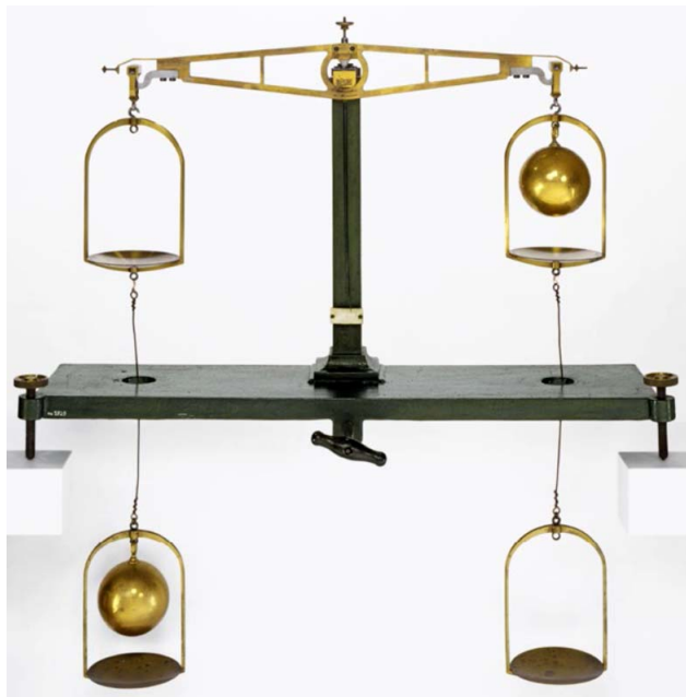
7. ábra. Jolly laboratóriumi kettős mérlege.
