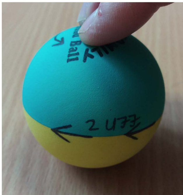
3. kép. Ha a labda tetejét két ujjal az óramutatóval ellentétes (ÓME) irányban körkörösén mozgatjuk, a labda lassan elforog az óramutatóval megegyező (ÓMM) irányban (lásd a fotóra kattintva induló videót). A labda tisztán gördül a pad felületén.
