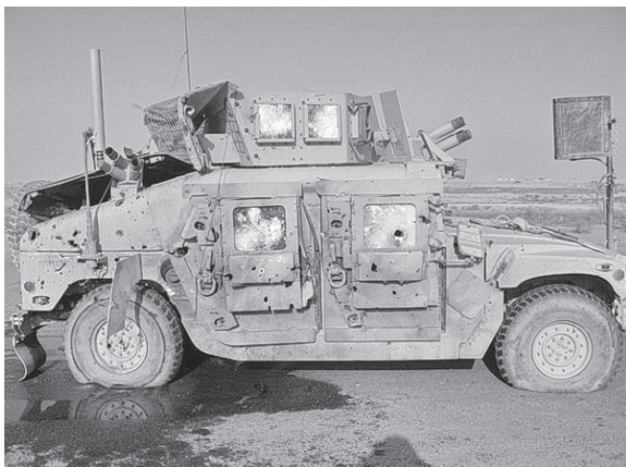
1. kép Egy HUMVEE EFP-vel végrehajtott csapás után 35
